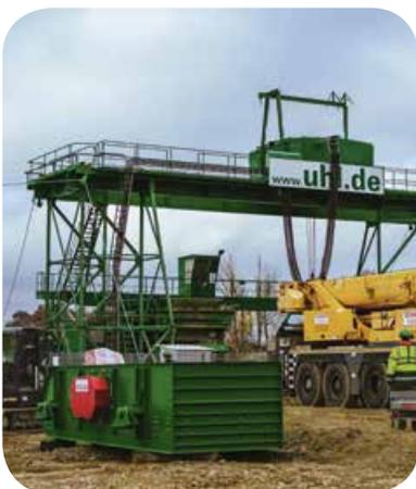
Der Tiefgreifer in Kork hat eine neue Entwässerungssiebmaschine. Sie soll die Effizienz des Tiefgreifers erhöhen. Der Einbau war eine kleine technische Meisterleistung, denn das Sieb mit der gewünschten Leistung ist knapp 20 Prozent länger als sein Vorgänger. Damit es passt, wurde die Idee geboren, eine etwas flachere Ellipsen-Siebmaschine einzubauen, und diese um fünf Grad zu kippen.
