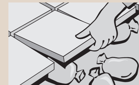
Verlegung auf Mörtelsäckchen
