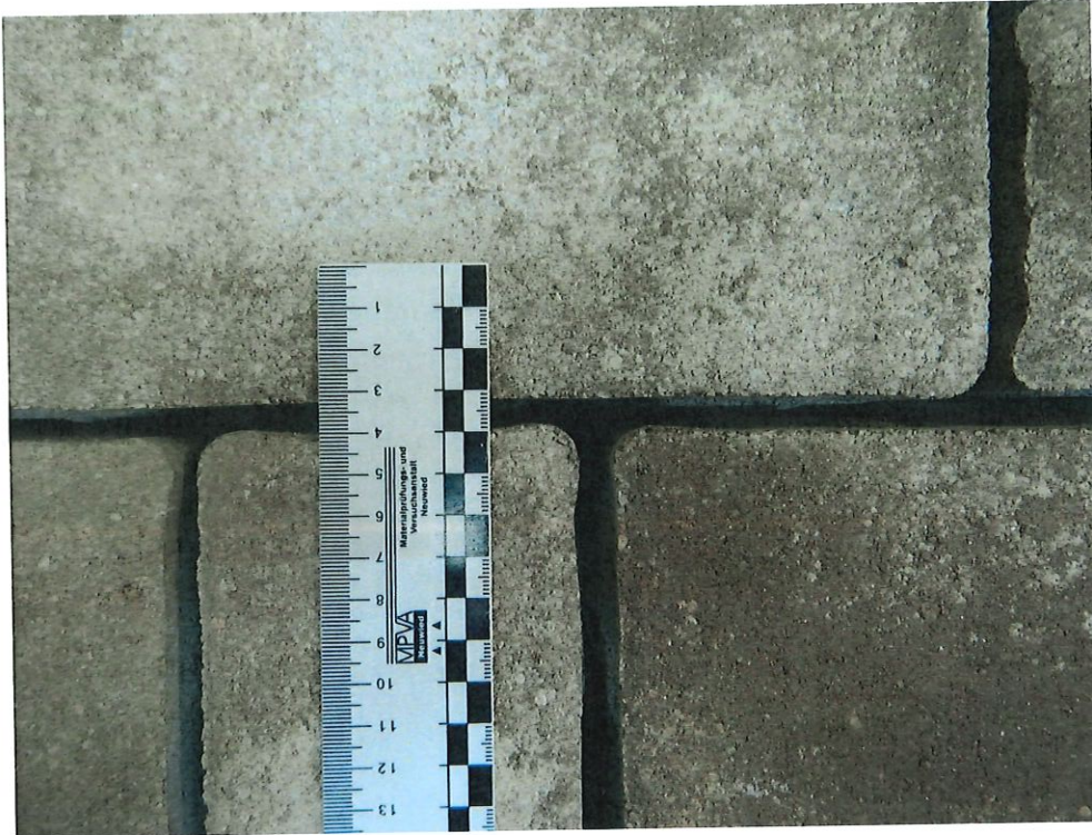
Bild 4: Resultierende Fugenbreite mit Fugenfüllung
