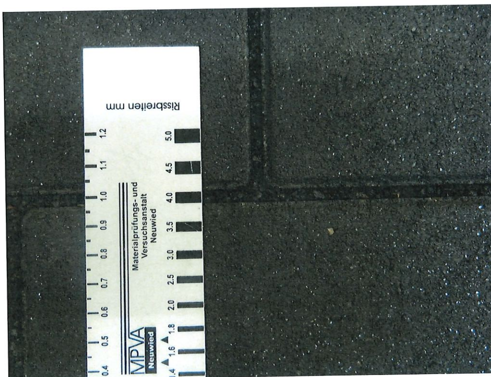
Bild 4: Resultierende Fugenbreite mit Fugenfüllung
